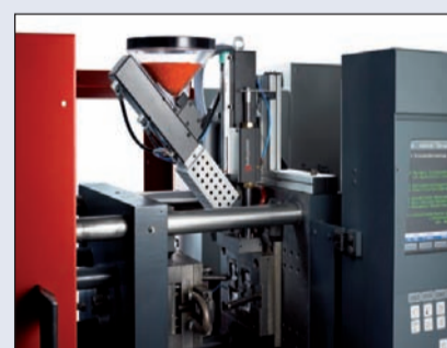
Les UAI peuvent être facilement montées sur les outillages d'injection, avec leurs commandes mobiles installées en pied de presse.
