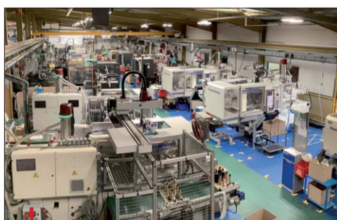
Triple C exploite un parc de 25 presses à injecter de 25 à 800 t.
