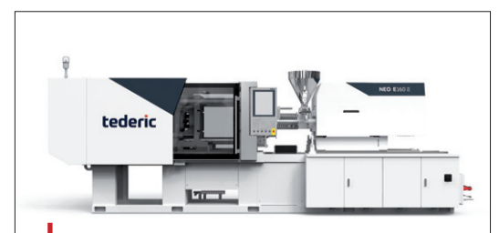
Cette presse Tederic 160 t produira simultanément un porte-gobelet et trois gobelets.
