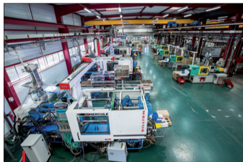
L'atelier est doté d'un parc récent de presses de bi- et tri-injection Billion, Ferromatik et Arburg.
