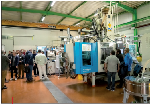
Le centre d'essais d'outillages de Novatra dispose de cinq machines KM, dont deux équipées pour la bi-injection.
