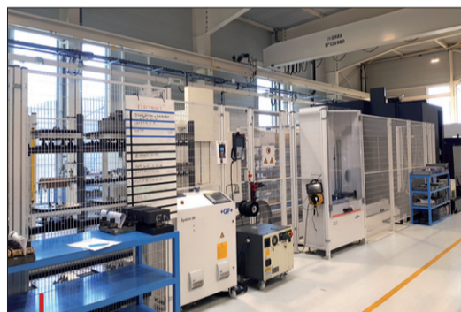
Cette ligne robotisée GF Agie-Charmilles augmente les capacités de production automatisée des empreintes, nécessitant jusqu'à 150 h/machine.
