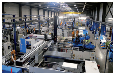
Gallez Injection est équipée de 13 presses bi- et tri-matières jusqu'à 650 t.
