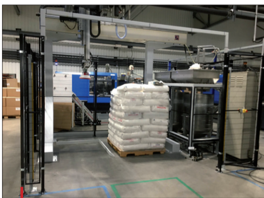
Mabin conçoit des palettiseurs/dépalettiseurs automatiques équipés d'une interface « no-code ».
