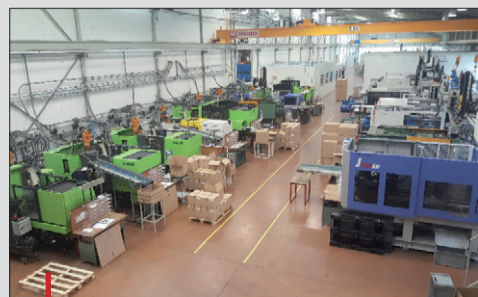
Siplast dispose d'une quinzaine de presses de 15 à 350 t.
