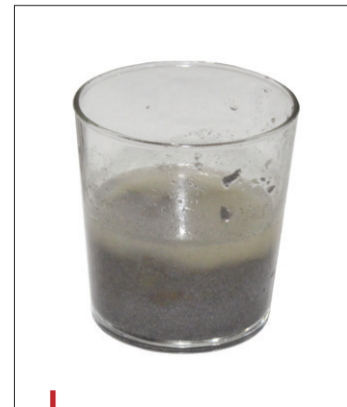
Rectification : déchets de type « boue D.I.D » demandant un traitement de dépollution spécifique.
