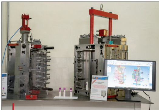
Le mouliste a développé des armoires de pilotage autonomes des mouvements des outillages.
