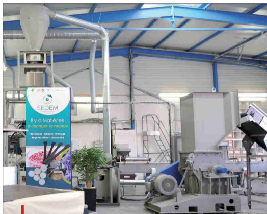
Sedem s'est équipée en 2023 d'équipements de recyclage comprenant un broyeur et une ligne de compoundage bivis.
