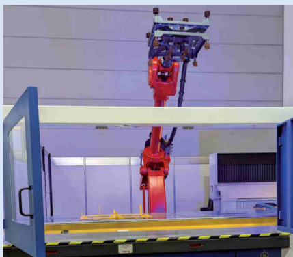
Un robot 6 axes assure le transfert des pièces formées vers le poste de découpe-détourage.
