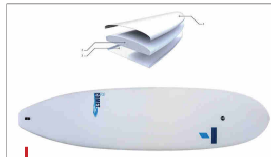
Le Comet est le 1 er surf recyclable, 95% de la masse de la planche étant composée de PEHD et PSE facilement séparables.
