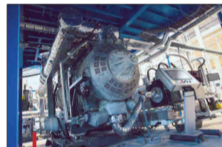
Le réacteur LSP élimine les dernières impuretés et garantit un rPET de qualité alimentaire.
