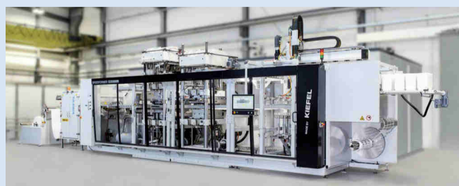
KMD 78.2 Premium : des cadences jusqu'à 45 cycles/mn.
