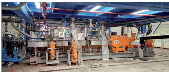
La nouvelle ligne Leistriz autorise des opérations de compoundage complexes en extrusion réactive.
