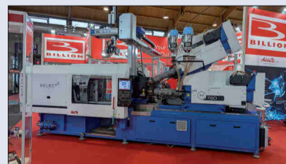
Outre les deux unités d'injection en V, la presse Select 2 était équipée d'une unité auxiliaire Billion Plug&Play pour surmouler la 3 e matière.
