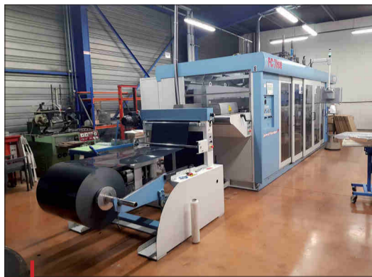
Les trois thermoformeuses WM identiques permettent de lancer aisément la production de différentes quantités de pièces.
