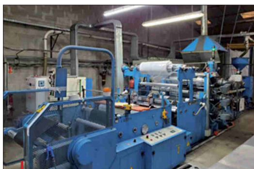
La ligne d'extrusion à filière plate permet de réintégrer un pourcentage élevé de recyclés dans les productions.
