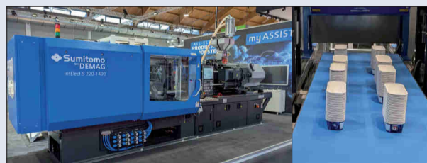
Compacte, propre et très rapide, cette presse produisait près de 3 600 barquettes décorées IML par heure.
