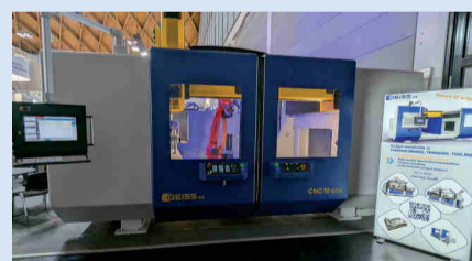
Les centres CNC 10 sont équipés d'une grande variété d'outils d'usinage, de découpe ou de détourage.
