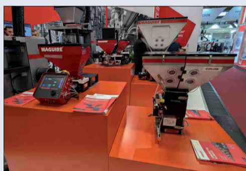
Deux exemplaires représentatifs de l'offre Maguire en doseurs gravimétriques : doseurs MGF (à gauche) et WSB (à droite).
