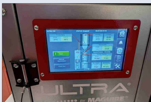
L'écran tactile permet de surveiller et programmer aisément doseurs et sècheurs.
