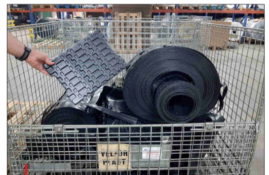
La circularité des lisières d'extrusion et des squelettes de thermoformage est gérée en interne.
