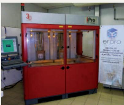
Machine de stéréolithographie iPro 9000 XL de 3D Systems. Erpro dispose de 4 machines de cette gamme dans son atelier.
