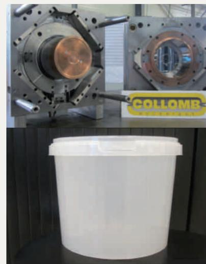
Le seau de 5 l, 37 % plus léger qu'un seau traditionnel, et son moule réalisé par la société Collomb Mécanique.
