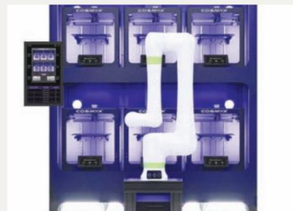
Micro-usine 3D Mira équipée d'un cobot Fanuc assurant le déchargement automatisé des plateaux porte-pièces.
