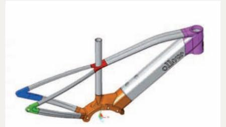
Visuel 3D mettant en évidence les zones d'assemblage en thermoplastique renforcé. (Source Ollow - Protoform)
