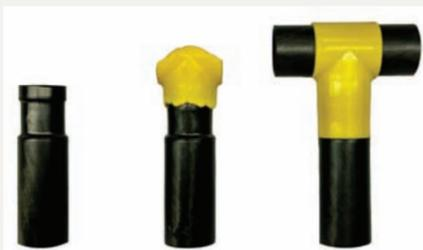
Différentes étapes de surmoulage de tubes (de gauche à droite) : tubes en fibres continues avant Supermoulage, tubes à moitié surmoulés, puis tubes assemblés.
