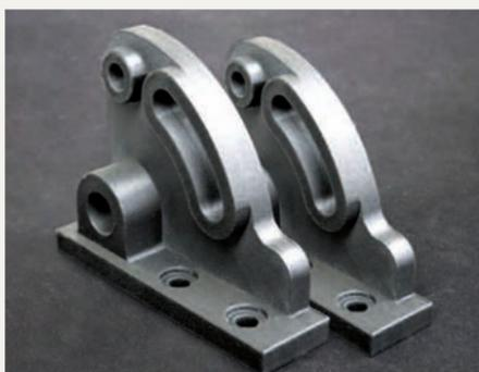
Avec 2 têtes d'impression travaillant simultanément, la configuration IDEX offre d'importants gains de productivité. À gauche : ce double outillage poka-yoke en PA6 de 120x120x25mm a été imprimé en une heure – à droite : chacun de ces supports de capteurs en ABS renforcé fibres de carbone (35x12x50 mm) est fabriqué en 12 mn.
